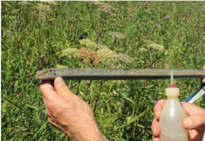
Abbildung 14: Salzsäuretest zur Bestimmung des Karbonatgehalts im Boden; erfolgt kein sicht- und hörbares Aufbrausen, ist der Boden karbonatfrei. (© Sonja Keiblinger)
