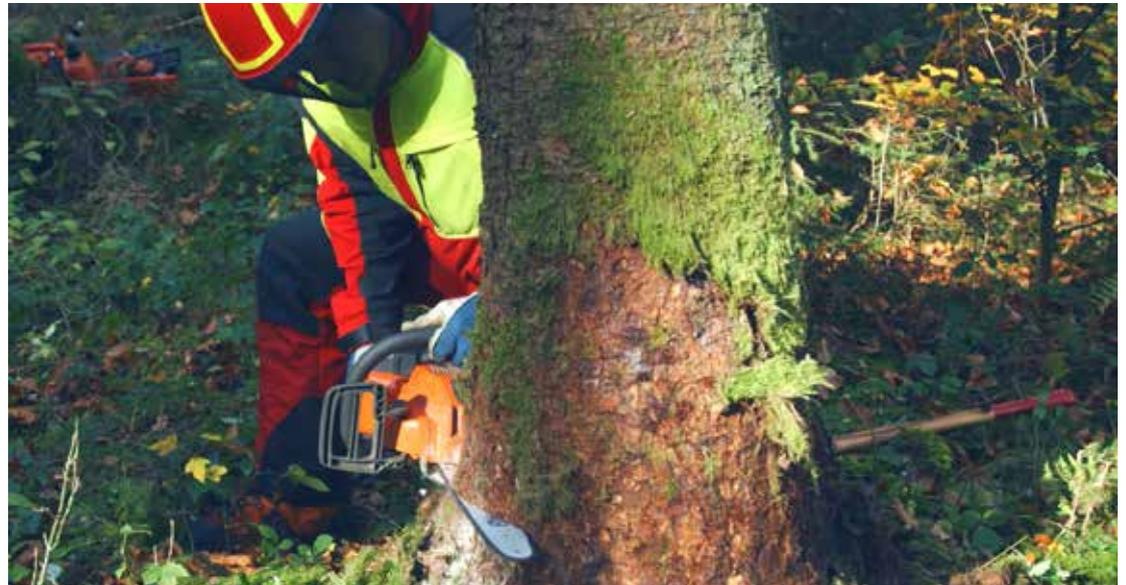
Ab einem Brusthöhendurchmesser (BHD) von etwa 25 Zentimetern konnte die Akkusäge mit der stärkeren Benzinmotorsäge nicht mehr mithalten, sehr wohl aber mit der schwächeren.
