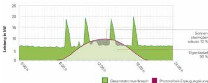
In Betrieben mit mechanischen Lüftungsanlagen (z. B. Schweinemaststall) kann bei einer richtig dimensionierten Photovoltaik-Anlage ein hoher Eigenverbrauchsanteil erzielt werden.
