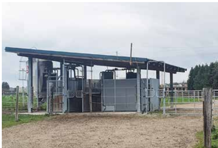
Kraftfutterstation mit Silo für die Transponderfütterung, besser bekannt als Abruffütterung. Jedes Pferd kann sich mehrmals täglich seine individuelle Futtermenge abholen. Fotos: Stefanie Wagner/LK NÖ
