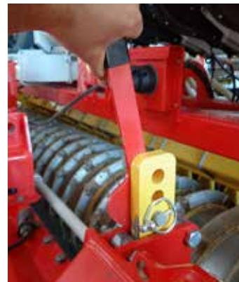
Mit dem mitgelieferten Hilfswerk- zeug kann man die hintere Prall- schiene an der Kreislegege leicht verstellen.
