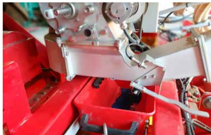
Mit Hilfe der selbsterklärenden Menüführung im Terminal lässt sich der Abdrehprobe einfach durchführen und die abgedrehte Menge mit der an einem Schlitten geführten Schale auffangen.
