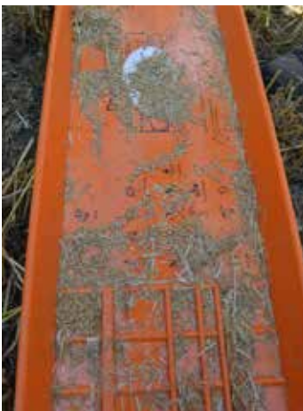
Eine richtig eingesetzte Prüfschale erleichtert die Kontrolle der Kornverluste in der Praxis.
