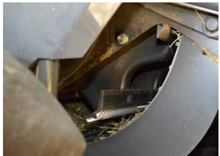
Eine möglichst parallele Dreschkorböffnung sollte man anstreben, als guten Kompromiss zwischen Durchsatzleistung, Ausdrusch und Kornqualität.
