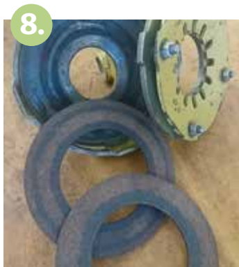
Die Reibkupplung gehört gelüftet, das heißt, die vier Sechskantmutter werden angezogen, so kann die Kupplung von Hand durchgedreht werden. Wenn die Reibscheiben gebrochen sind, gehört die Reibkupplung, wie abgebildet, komplett zerlegt und die Reibscheiben werden ersetzt.
