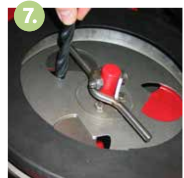
Durch die jahrelange Benutzung arbeiten sich die Gelenke und Lager der Dosier- und Verteileinrichtungen ab. Bei diesem Streuer dient ein zwölf Millimeter Spiralbohrer dazu, die Dosierschieber auf beiden Seiten wieder exakt zu justieren.
