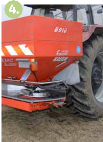
Der abgerissene Schmutzfänger kann seine Aufgabe nicht mehr erfüllen. Fotos: Reinhard Hörmansdorfer/LK NÖ
