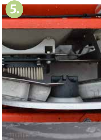
Der verschlissene Bürstensaum führt zu vielen unkontrolliert abgeworfenen Düngerkörnern.
