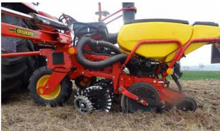
Einzelkornsämaschine für Direktsaat mit Coulter Discs
