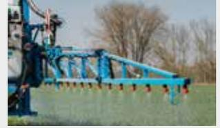
Alle in Gebrauch befindlichen Pflanzenschutzgeräte müssen regelmäßig durch autorisierte Werkstätten überprüft werden. Ausgenommen von dieser Überprüfungspflicht sind handgehaltene, schulter- und rückertragbare Geräte sowie Geräte, die ausschließlich der Ausbringung von Nützlingen dienen.
