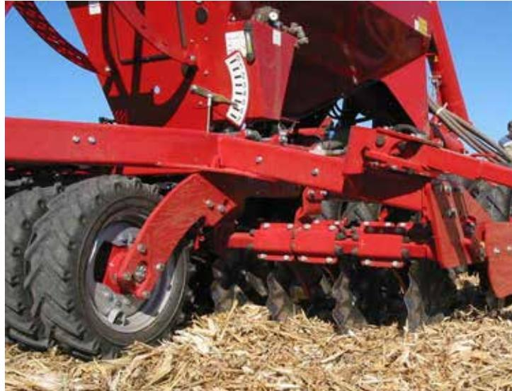
Wellscheiben zum Aufschneiden des Säschlitzes und zur Produktion von lockerer Erde zum Schließen des Schlitzes. Das Saatgut soll wegen der Kapillarität auf dem unberührten Horizont liegen und von lockerer, nicht verdichteter Erde bedeckt sein.
