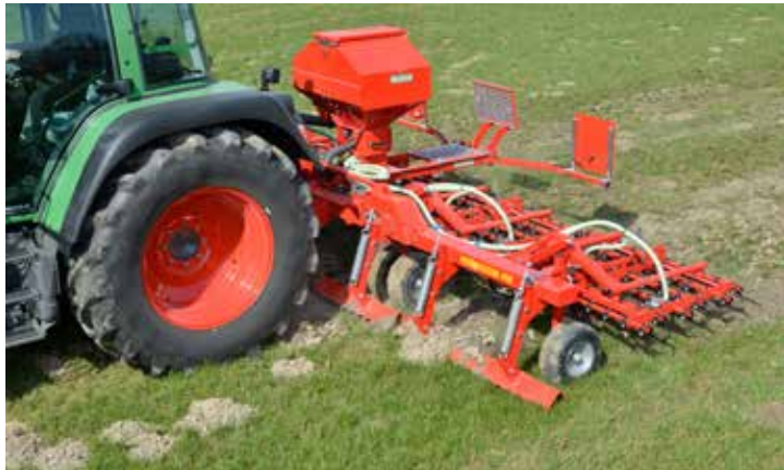
Zur klassischen Nachsaattechnik gehört unter anderem ein Planierschild, um Maulwurfshaufen und Unebenheiten zu nivellieren.
