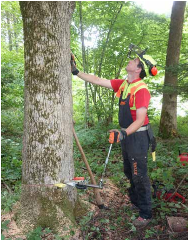
Der Ratschenkeil im Einsatz: Er verhindert weitgehend, dass durch die beim Umkeilen hervorgerufenen Stöße und Vibrationen Totäste nicht abbrechen.
