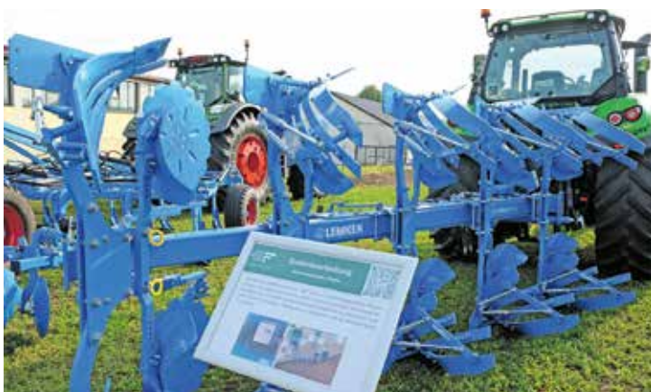
Mithilfe des ISOBUS-Bausteines „TIM“ kann ein flächenangepasstes Pflügen erfolgen.
