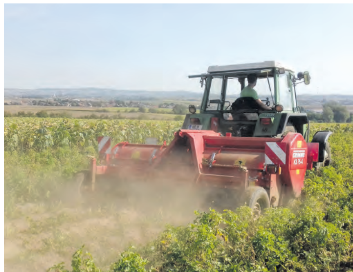
Krautschläger, die speziell für den Erdäpfelbau entwickelt wurden, legen das Kraut in den Furchen ab. Die Stängel werden damit nicht überdeckt und Folgebehandlungen mit Pflanzenschutzmitteln sind möglich.
