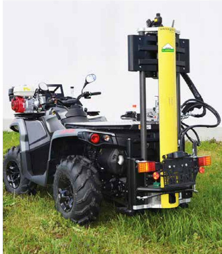
Die Probenahme erfolgt bodenschonend mit einem Quad.
