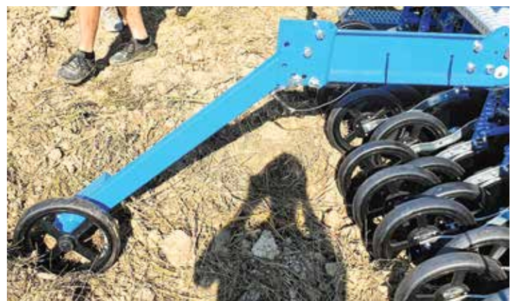
Bild 4: Das Fahrgeschwindigkeitssignal kann über das hinten abgeklappte Bodenrad zum Erfassen der tatsächlichen Fahrgeschwindigkeit verwendet werden. Diese Methode ist aber für kleine Flächen nicht ideal.
