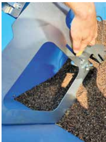
Bild 2: Am Saatkasten befindet sich ein Füllstandsensoren.
