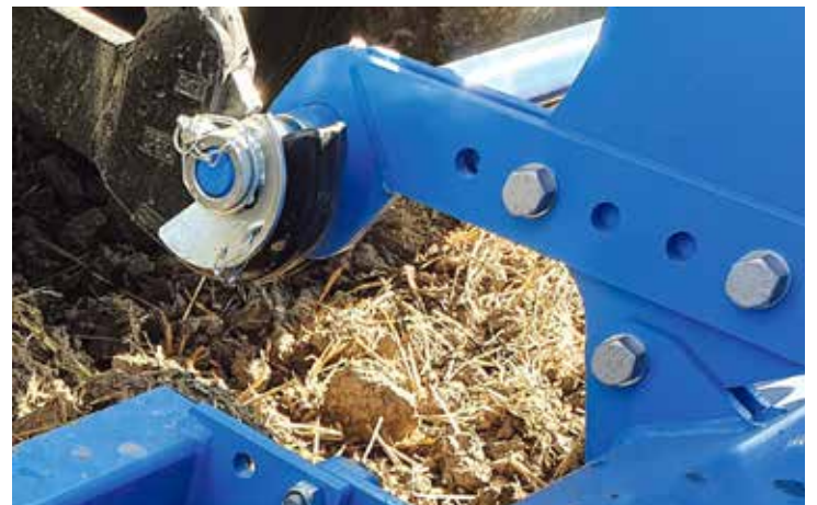
Bild 1: Die Unterlenkerwelle ist nach vorne und nach hinten verstellbar und die Maschine kann so an jeden Traktor gut angepasst werden.
