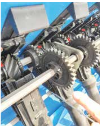
Bild 6: Die „Blockierzahnräder“ müssen an der „richtigen“ Position verbaut werden.
