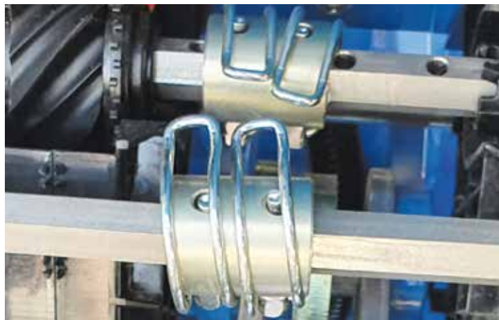
Bild 5: Maschine einfach halbseitig abschalten: Zwei Splinte an der geteilten Säwelle lösen, Verbindungsstück zur Seite schieben und sichern.
