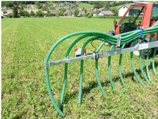
Schleppschlauch 1 € je m 3
