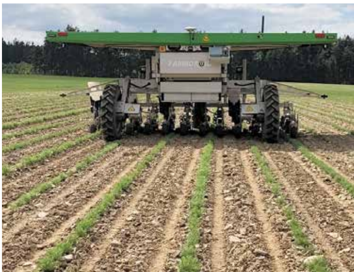
Der Farmdroid wurde von der Innovation Farm getestet. An relativ sonnigen Tagen können die vier Solarpanels auf dem „Dach“ des Roboters bis zu 20 Kilowattstunden pro Tag erzeugen.
