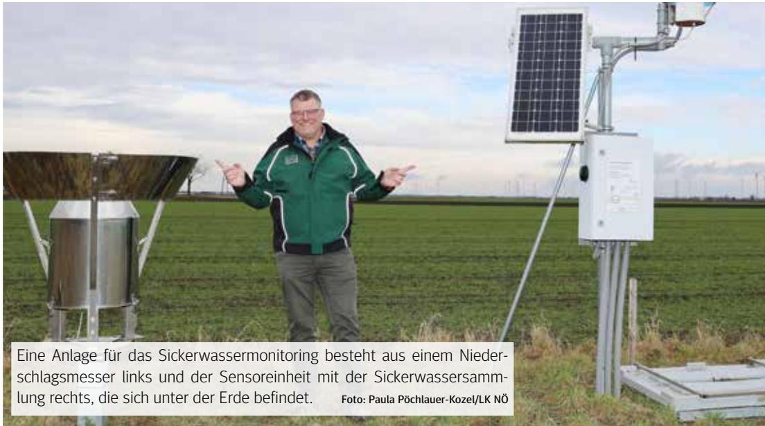
Eine Anlage für das Sickerwassermonitoring besteht aus einem Niederschlagsmesser links und der Sensoreinheit mit der Sickerwassersammlung rechts, die sich unter der Erde befindet. Foto: Paula Pöchlauer-Kozel/LK NÖ
