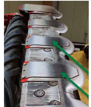
Sichtkontrolle der Gleitkufen beim Scheibenmäherwerk
