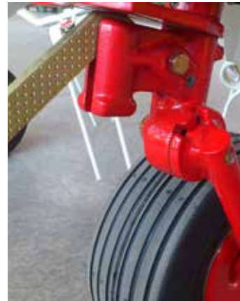
Feinverzahnung zum Verstellen des Streuwinkels
