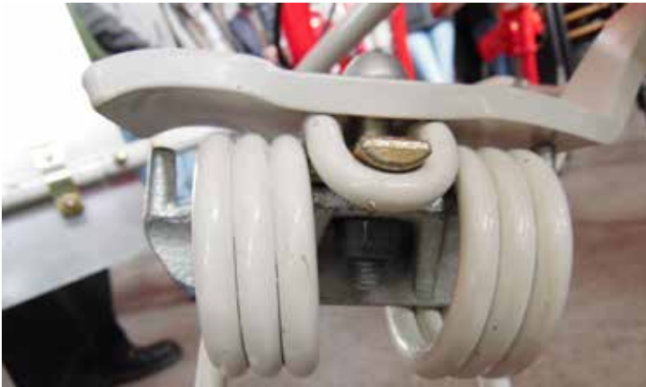
Eine Zinkenverlustrückmeldung hält abgebrochene Zinken am Kreisel und verhindert so Schäden an den nachfolgenden Maschinen.
