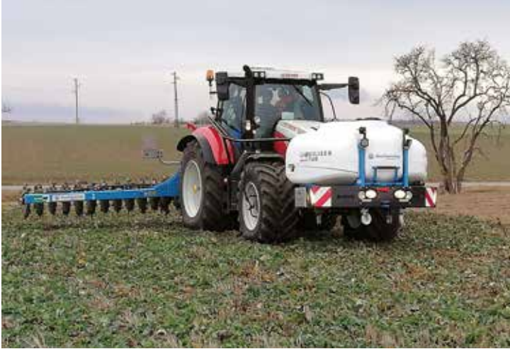
Stickstoff kann man über Depotdüngung, wie das CULTAN Verfahren mit flüssigen Düngern einbringen.
