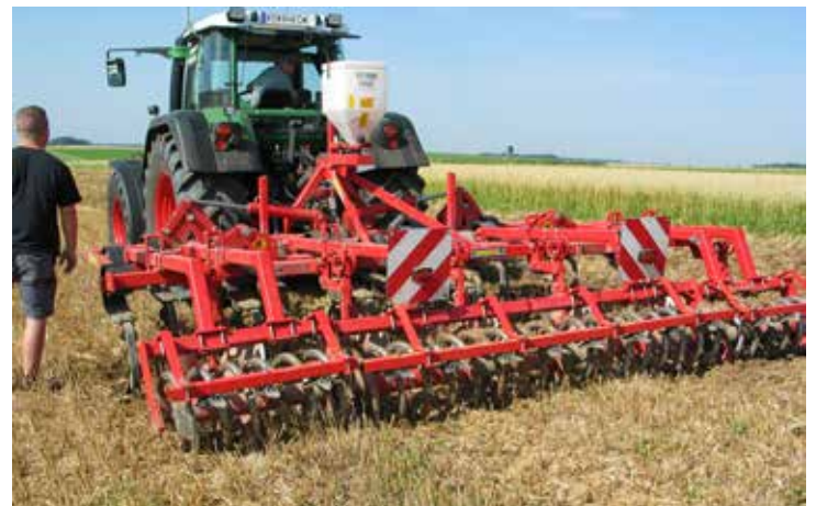
Mit dem Grubber sollte man so flach wie möglich fahren, um Ausfallgetreide zu bekämpfen und die Verdunstung zu verringern.
