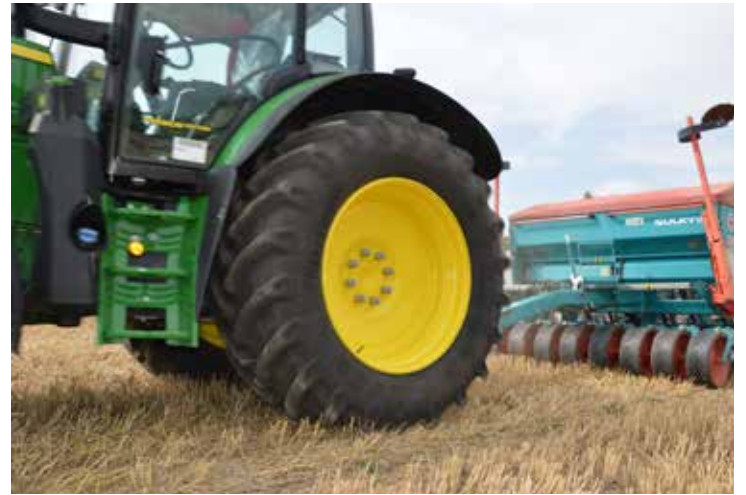
Mit einer Mulch- und Direktsaatmaschine kann man Haupt- und Zwischenfrüchte direkt in die Erntereste säen.
