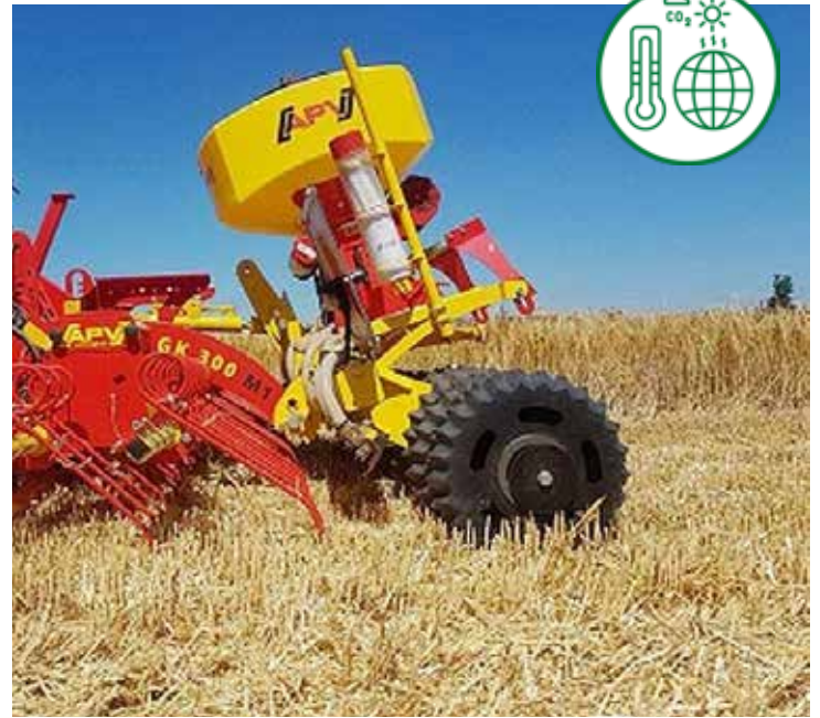
Auch bei hohen Strohmassen kann man den Rotorstriegel einsetzen, ohne dass es zu Verstopfungen kommt.
