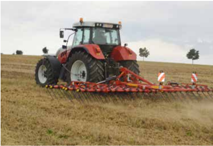
Schwerstriegel mit hydraulisch in der Neigung verstellbaren Zinken mit 16 Millimeter Durchmesser.
