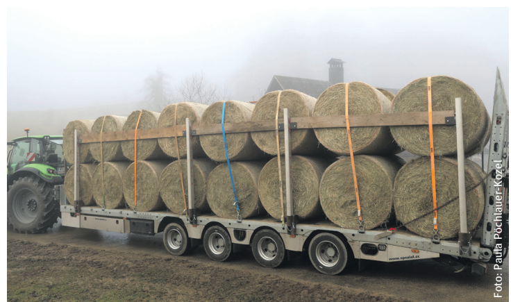
Besonders schwierig sind in der Praxis Ladegüter zu sichern, die beim Verzurren „nachgeben“, wie zum Beispiel Stroh- und Heuballen. Wenn möglich, ist auch hier die formschlüssige Ladungssicherung zu bevorzugen.
