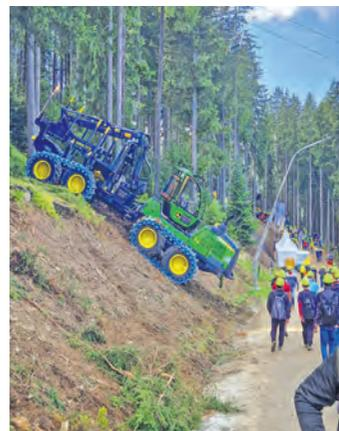
Mittels Anbau- bzw. externer Seilwinde können sich auch radgetriebene Maschinen in steilerem Gelände fortbewegen.
