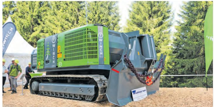
Die ausgestellte T-Winch 30.3 hat ein Eigengewicht von 33 t und ein Aggregat mit 441 PS. Ihre Last hält sie auf einem 560 m langen Stahlseil mit einer Zugkraft von rd. 18 t. Sie wird für Übersee produziert. Bei uns kommt die „kleine Schwester“ 10.3 mit 10 t Zugkraft zum Einsatz. Diese Winden sichern Harvester und Forwarder beim Einsatz in Steillagen.
