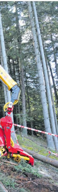
Der „Highlander“ ist ein schweres Universalgerät. Dieser Harvester wiegt 25,5 t und kann optional mit Rück-, Traktionswinde und/oder Klemmbank ausgestattet werden.
