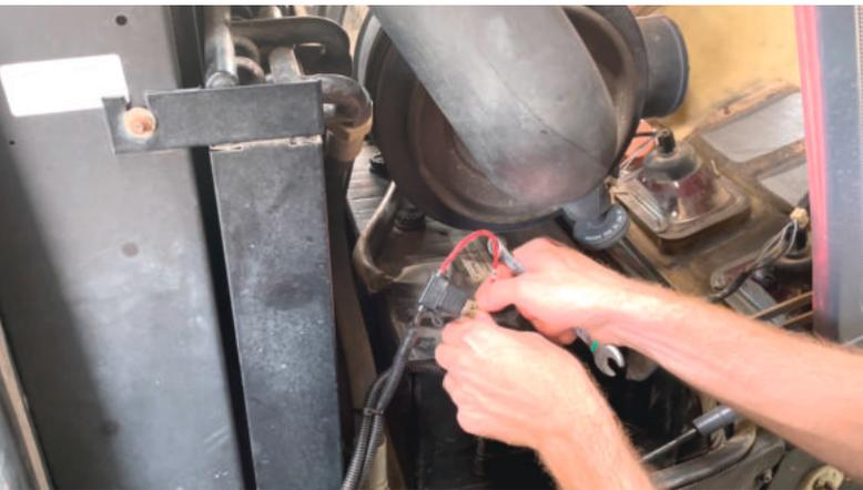
Das Sveaverken wird direkt an der Traktorbatterie angeschlossen. Der Hauptschalter kappt die Verbindung und wurde am Aschenbecher montiert.
