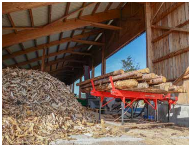
Den eigenen Sägeschnidspalter der Marke „BGU KSA 450 EZ“ setzt er für Stammdurchmesser unter 25 Zentimetern ein. Im Vorjahr hat er rund 70 Raummeter Scheitholz damit produziert. Fotos: Paula Pöchlauser-Kozel/LK NÖ (7)
