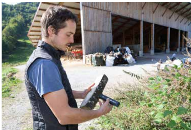
Thoma Zöchling kontrolliert während des Trocknungsprozesses regelmäßig und stichprobenartig die Holzfeuchte mit einem Messgerät. Der Wassergehalt soll so rasch wie möglich von 60 auf 20 Prozent sinken.
