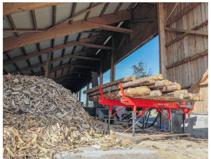
Den eigenen Sägeschnidspalter der Marke „BGU KSA 450 EZ“ setzt er für Stammdurchmesser unter 25 Zentimetern ein. Im Vorjahr hat er rund 70 Raummeter Scheitholz damit produziert. Fotos: Paula Pöchlauer-Kozel/LK NÖ (7)
