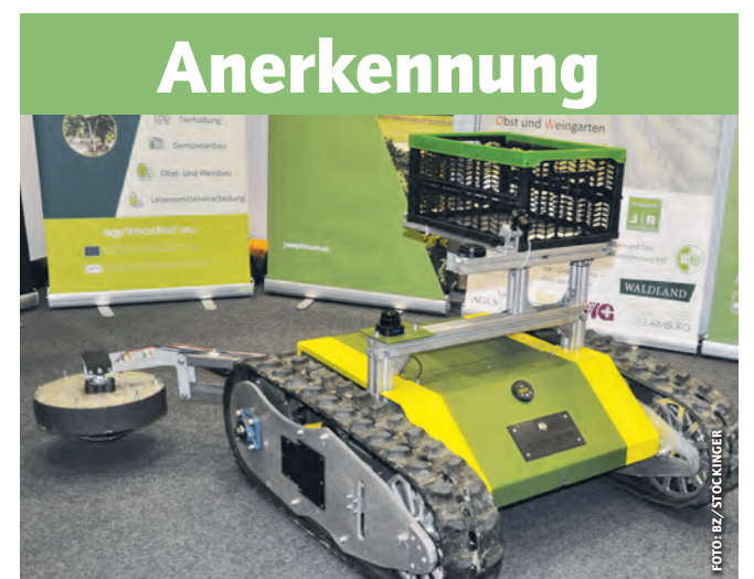
Der Wein- und Obstbauroboter „Dionysos“ von Josephinum Research, hier mit Ausrüstung zum Zwischenstock-Mähen und Transportieren
