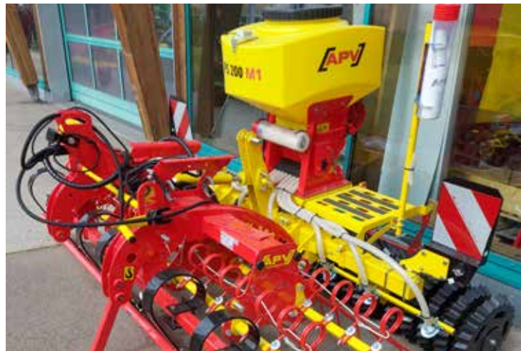
Grünlandsanierungsstriegel samt aufgebautem pneumatischem Sägerät. Der Saatgutbehälter ist zentral platziert.
