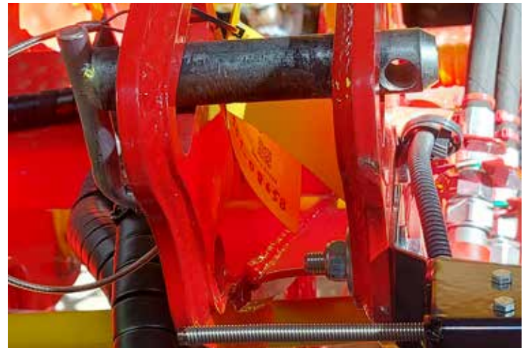
Der Oberlenkertastschalter wird bei ausgehobenem Gerät betätigt und die elektrisch angetriebene Säwelle wird abschaltet. Fotos: Hauer Gottfried/LK NÖ
