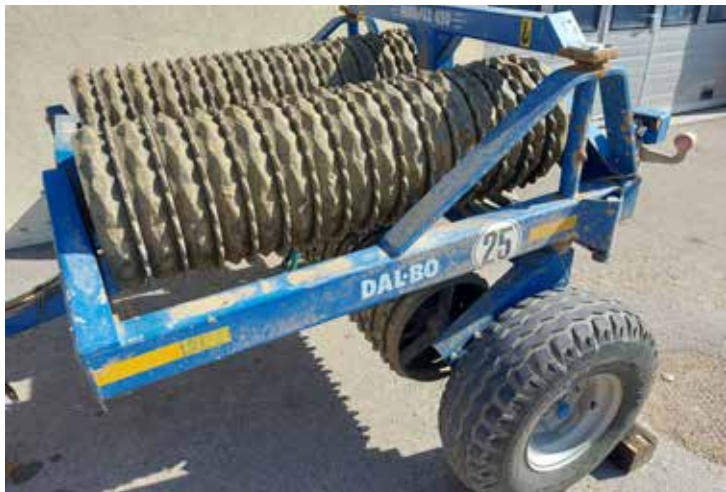
Nach der Saat kann man mit einem im Anschluss folgenden Walzdurchgang den Bodenschluss herstellen.
