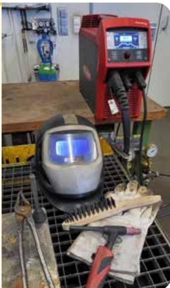
Beim sauberen WIG-Schweißverfahren entstehen keine Schlacke, kaum Spritzer und wenig Schweißrauch. Das Ergebnis sind glatte und saubere Nähte. Allerdings muss man zuvor sauber arbeiten. Das soll heißen, Nahtflanken blank schleifen, Öl-, Fett- oder Farbrückstände bei der Vorbereitung restlos entfernen. An die Produktivität dürfen keine zu großen Ansprüche gestellt werden. Die Schweißgeschwindigkeit ist vergleichsweise niedrig. Das Einsatzgebiet liegt bei Werkstücken mit kleineren Wandstärken.
