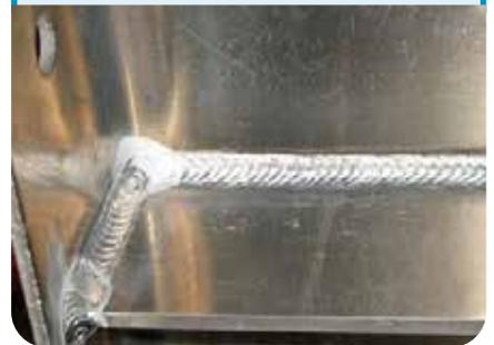
Dieser Grenzstreuschirm ist aus zwei Millimetern Nirosta-Blech gefertigt. Das Fügen dieser Bleche geschieht typischerweise mit dem WIG-Schweißen.
