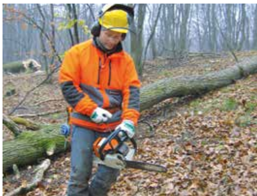
Starten der Motorsäge im warmen Zustand
