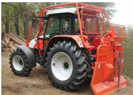
Forsttraktor mit angebaute Seilwinde
