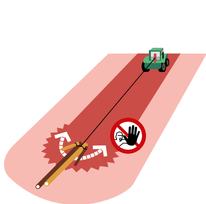
Gefahrenbereich beim Bodenseilzug
