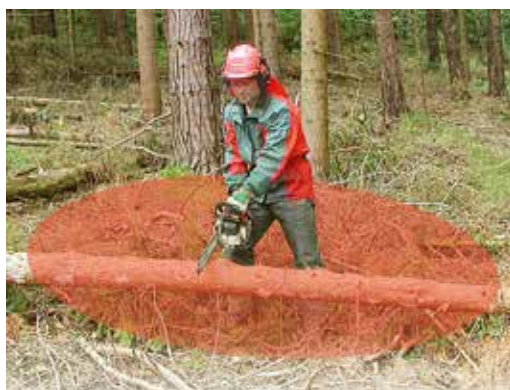
Schwenkbereich der Motorsäge – 2 Meter Sicherheitsabstand
