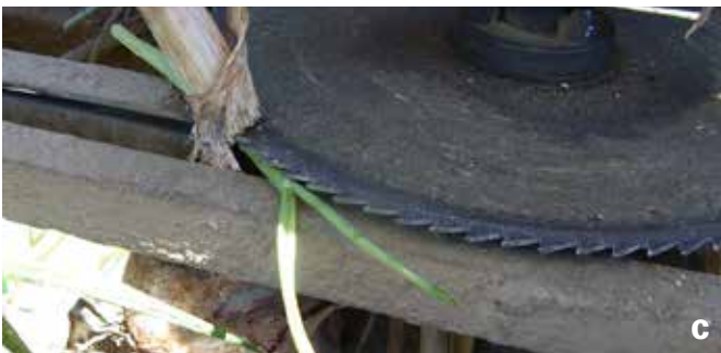
Abb. 18: Knoblauchernte mit dem Klemmbandroder: Der Boden wird gelockert (a), die Pflanzen werden am Laub aus dem Boden gezogen (b), die Zwiebel wird vom Laub getrennt (c) und in einen Transportbehälter abgelegt (d) (Fotos: J. Keferböck, LKNÖ).
